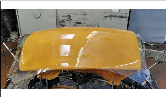
Streckziehprozess einer Kunststoffscheibe Eigene Darstellung
