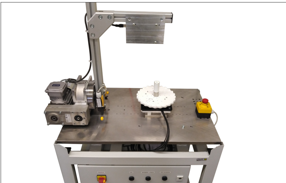
Abb. 3: Messzelle mit dem integrierten Motor am Messarm Eigene Darstellung
