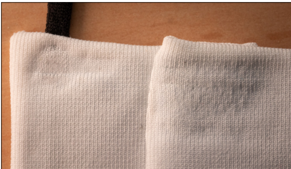
Fügestelle des elastischen Bündels mittels Ultraschallschweissung (links) und der lasergeschweissten Faltung (rechts) Eigene Darstellung
