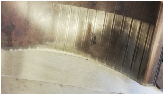
Verschleiss aufgrund der Reibung an Flächen und Kanten eines Feinschneidwerkzeugs
