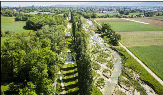
Renaturierung der Aire, links der aufgewertete Kanal und rechts das neue Flussbett, Kanton Genf (CH) (Espazium, 2017, Foto: F. Chironi)
