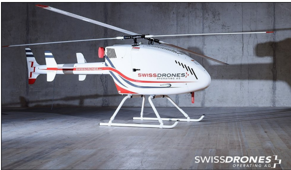
Abbildung 1: Die SDO 50 V2 von SwissDrones Operating AG Abmasse ohne Rotor in Meter (lxbxh): 2,32 x 0,7 x 0,92
