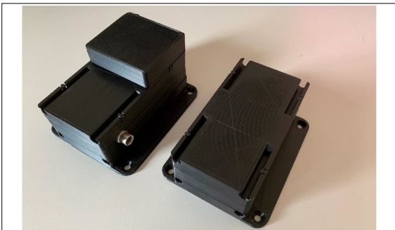
3D gedruckte Prototypen des modularen Gehäusekonzepts Eigene Darstellung
