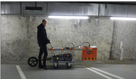
Georadar-Messausrüstung in Tiefgarage Eigene Darstellung
