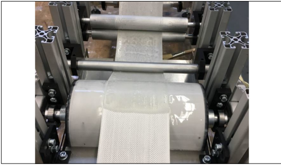
Über die Kiss Touch Walze wird die Matrix aus dem Harzbad den Fasern zugeführt und danach mit Walzen imprägniert
