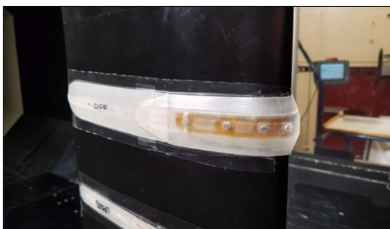
Gehäuse eines Differenzdrucksensors, während den Messungen im Windkanal der ETHZ. Eigene Darstellung
