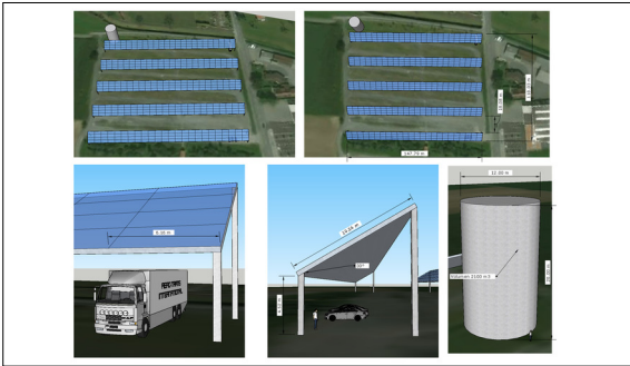
Konzeptentwurf einer möglichen Solarthermie Anlage als Parkplatzüberdachung
