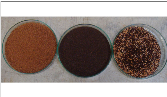
Verschiedene granulierten Eisenhydroxide, welche getestet wurden.
