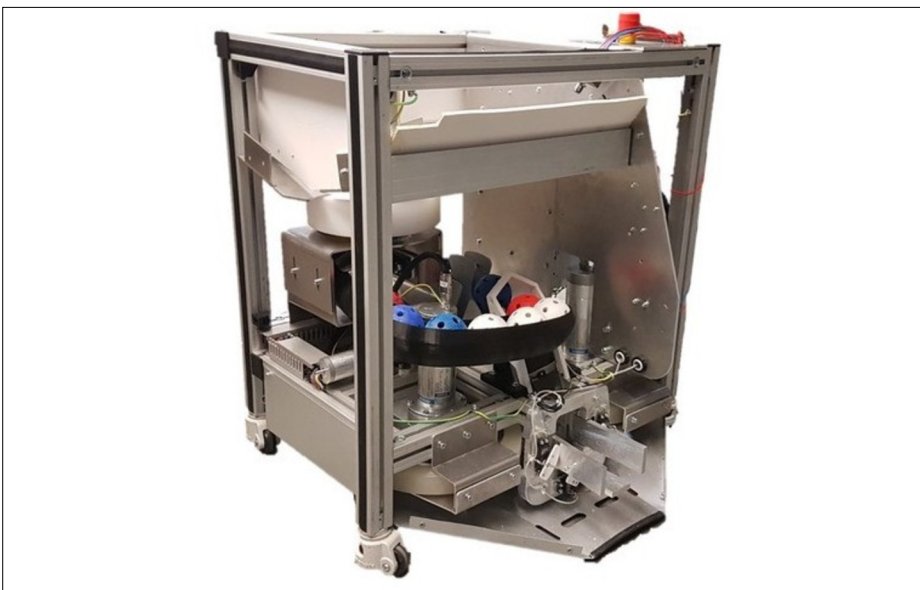
Ballschussmaschine mit eingebautem Vereinzlungsmechanismus Eigene Darstellung
