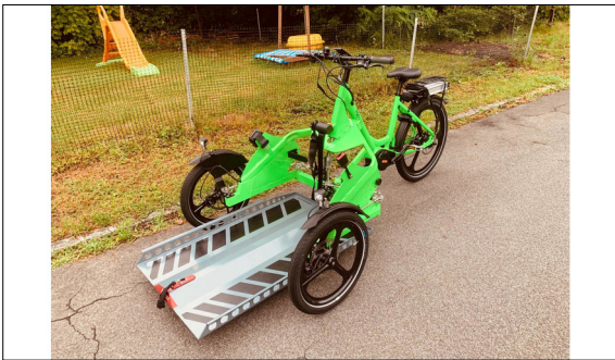
Lastenfahrrad für den Transport von behinderten Personen mit Rollstuhl HCP SWISS GmbH
