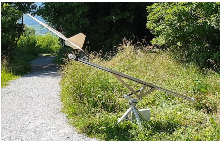
Versuchsdrohne beim Verlassen der Abschussrampe. Eigene Darstellung
