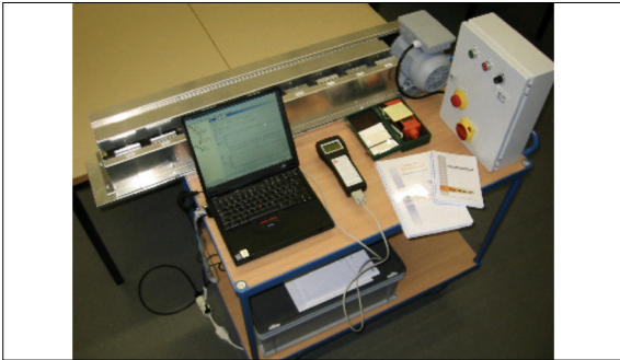
Alter Versuchsstand zur Ermittlung von Wälzlerschäden an der HSR. Eigene Darstellung
