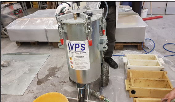
Mörtelpumpe der Winiger Pump System AG, welche für die Erstellung der Prüfkörper zum Einsatz kam
