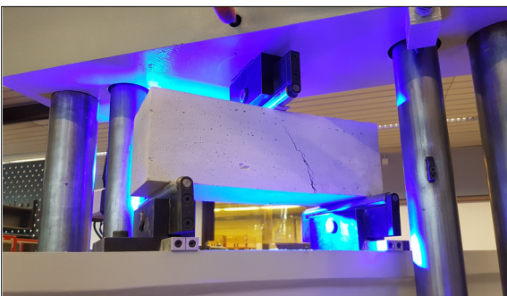
Prüfung der Prismen mit einem 3-Punkt-Biegeversuch
