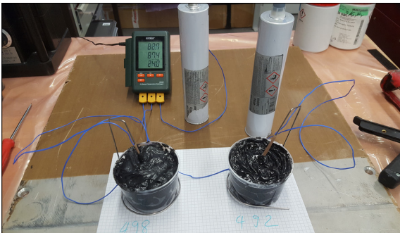
Versuchsaufbau zur Messung der Abkühlungskurve
