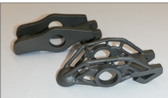
SLM gedruckte Kipphebel für Validierung (Originalstruktur 23 Gramm / optimierte Struktur 11 Gramm)
