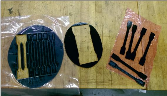
Erstellung von Platten als Grundmaterial, mit ausgeschnittenen Zugprüfkörpern
