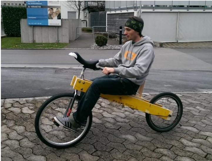
zweiter Prototyp: Kompaktes 2-rädriges E-Bike mit 250W Radnabenmotor am Hinterrad und Tretunterstützung direkt am Vorderrad
