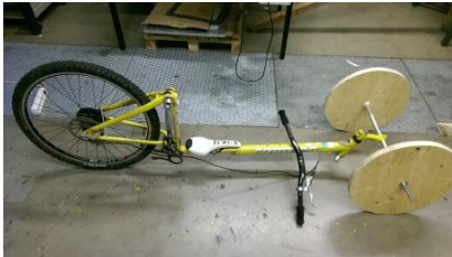
erster Prototyp: 3-rädrig, Lenkung über die Füße und Ruderantrieb
