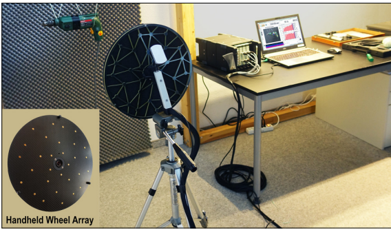
Mobile Messkette (Array, Frontend, Labtop) der neuen akustischen Kamera im Home-Office Eigene Darstellung
