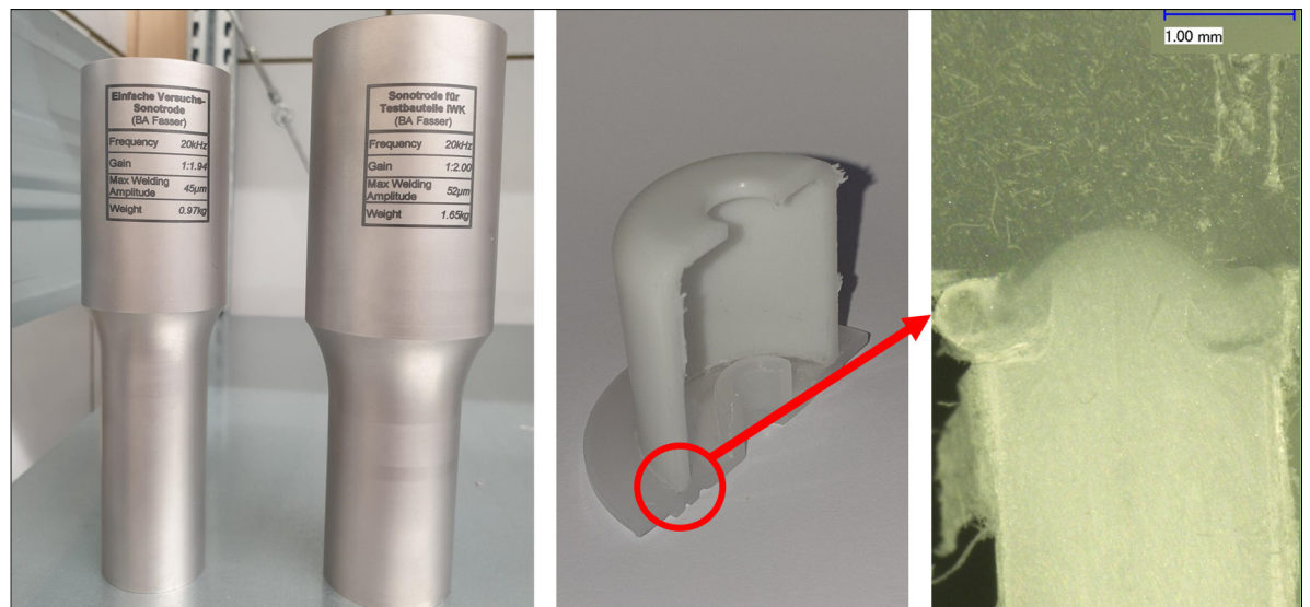
Abbildung 2: Von Links nach Rechts: Sonotrode, geschweißtes PP Bauteil, Schliffbild der Schweißnaht. Eigene Darstellung
