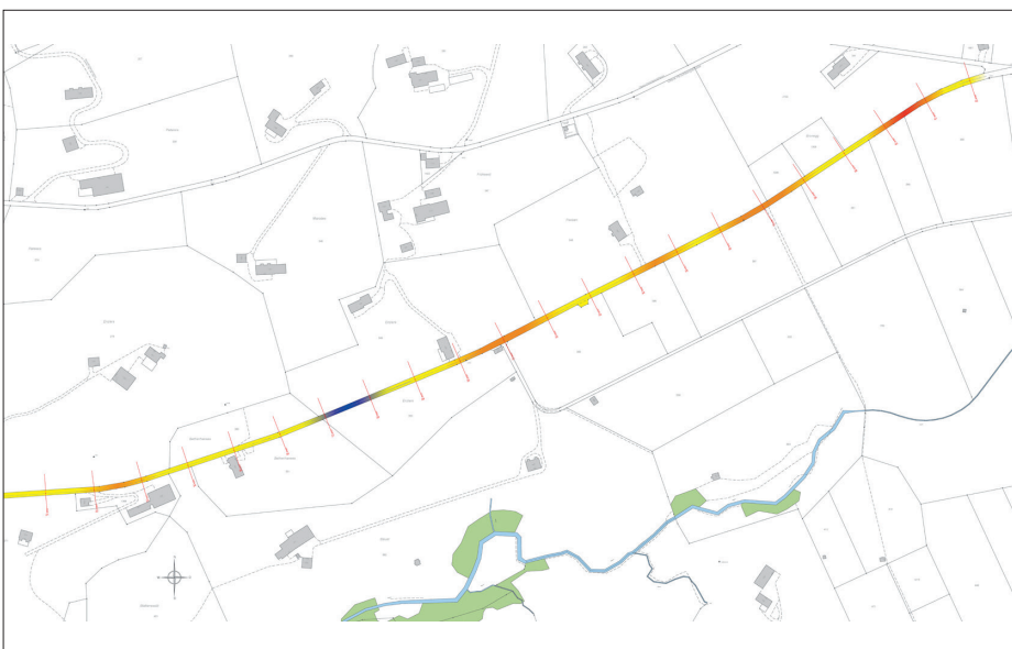
Ausschnitt der visuellen Zustandserhebung (rot = schlecht, orange = kritisch, gelb = ausreichend, blau = mittel)
