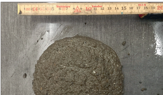
Prüfung des Ausbreitmasses mit Zellulosefasern als Zusatzmittel (adaptierte Prüfung)
