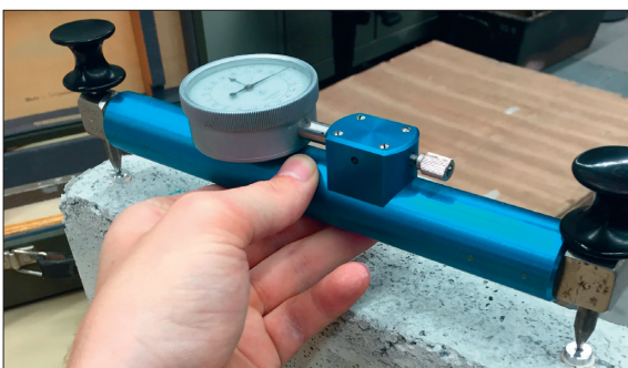
Messen eines Schwindmasses an einem Prüfkörper
