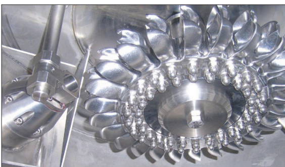
Pelton-turbine zur Stromproduktion
