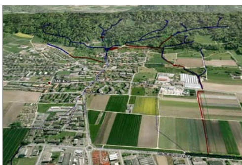
Übersicht über das geplante Entwässerungskonzept. Blau: bestehende Gewässer, rot; neu zu erstellende Gewässer; grün: aufzuhebende Gewässer
