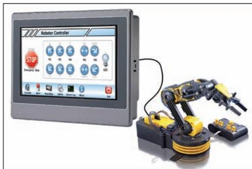
Roboter-Controller-Applikation auf Touch Panel
