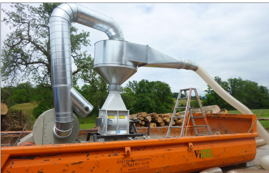
Funktionsmuster mit Saugsystem und Zyklon
