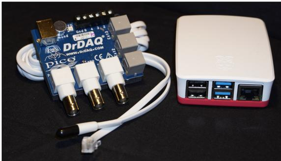
Raspberry Pi 4B mit DrDAQ Sensor Board und externem Temperatur-Sensor
