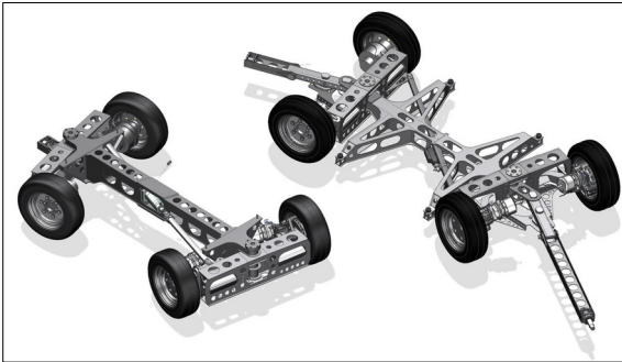
Chassis der Wegebahn, Links: Zugfahrzeug/ Rechts: Waggon
