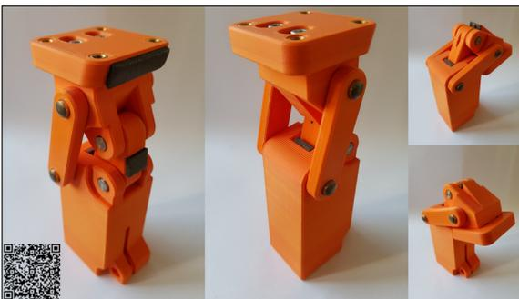
Prototyp des Kniegelenks aus dem 3D-Drucker
