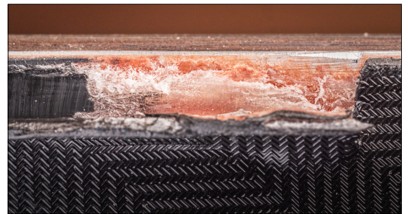
Reproduzierbar nachgestellte "Chipping" Verschleisserscheinung an der Deckschicht des Skis Eigene Darstellung
