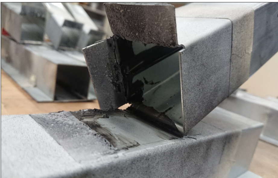
T-Stoss nach dem kohäsiven Versagen der Klebverbindungen
