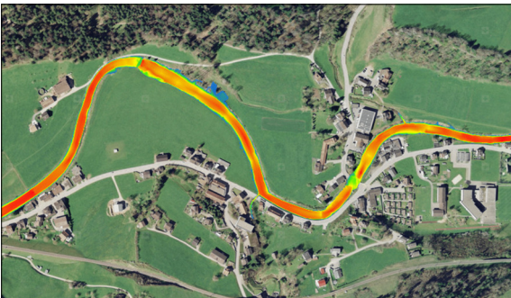
Modellierung Necker mit 40 Zellen auf 10 m Flussbreite Bundesamt für Landestopografie swisstopo [bearbeitet]
