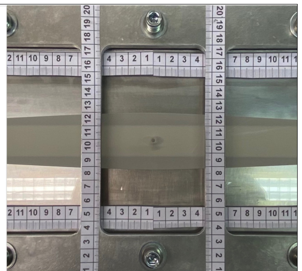
Vergleich Klebstoffausbreitung zwischen Versuch und Simulation, Kanalbreite 25 mm, Austragsrate 5 cm 3 /s Eigene Darstellung
