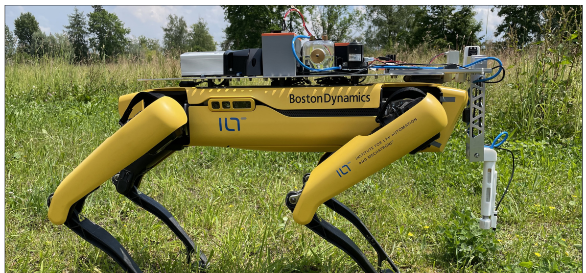
Spritze ausgefahren auf dem Spot Eigene Darstellung
