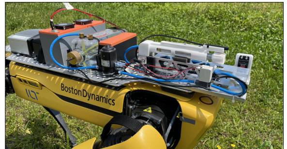
Spritze eingefahren auf dem Spot Eigene Darstellung
