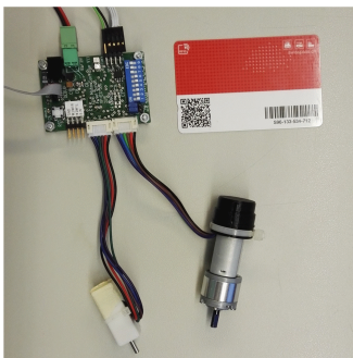
Die benötigte Fläche des Systems ohne Motoren und Anschlusskabel ist kleiner als jene einer Kreditkarte. Die Höhe misst knapp 1.5cm.
