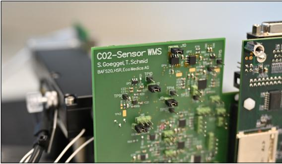
Prototyp optischer CO<sub>2</sub>-Sensor
