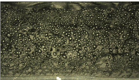
Integrale Schaumstruktur im Inneren des Demobauteils
