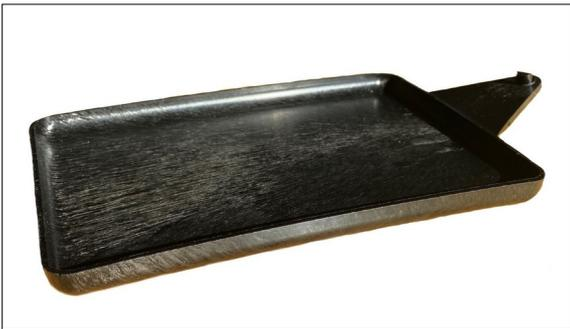
geschäumtes Demobauteil mit dreieckförmigem Bandanguss
