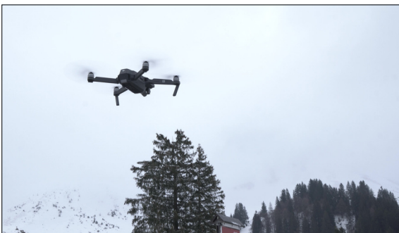
Eine DJI Mavic Pro Drohne beim Aufnehmen von Testvideos zum Trainieren des Deep Learning Modells. Eigene Darstellung
