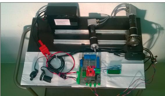
Vereinfachter Versuchsaufbau mit Akku, Platine, Stellgliedern, Generatoren und Controllern
