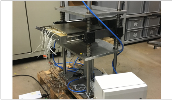
Automatisierte Anlage mit elektronischer angesteuerter Druckluftregelung zur Steuerung der Zylinderkräfte
