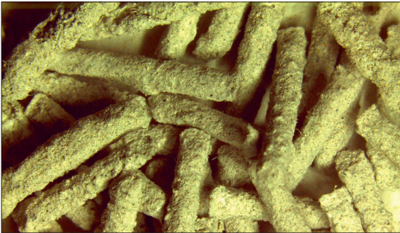
Aluminium-Drahtabschnitte mit Verbackungen nach 28 Tagen Lagerung in der Fraktion 0–0,250 mm
