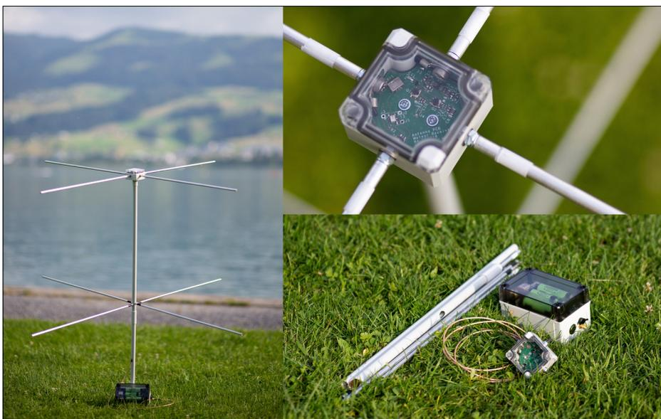
Gesamtssystem in aufgebautem Zustand, Antennen Board, Gesamtssystem in zerlegtem Zustand
