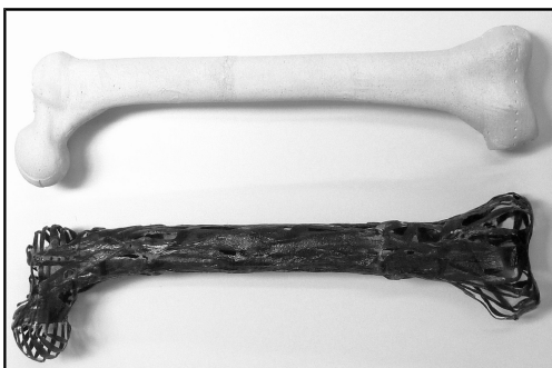
Wasserlöslicher Kern (oben) und Oberschenkelknochen aus Kohlenstofffasern (unten).
