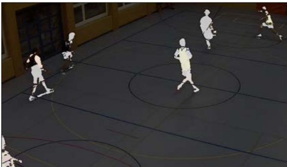
Aus Kamerabild extrahierter Vordergrund (weiss hervorgehoben) über Originalbild gelegt
