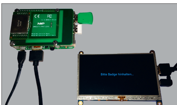
Testaufbau des Terminal-Clients mit Raspberry Pi inklusive Touch-Display und NFC Reader
