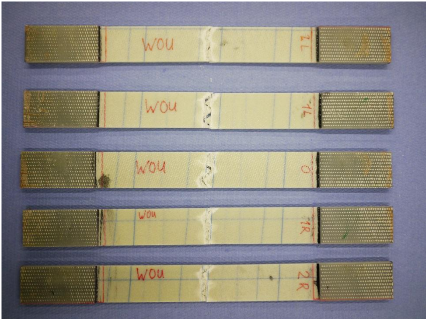
Beispiel der Zugproben nach der Prüfung
