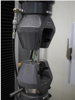
Zugprüfung einer Probe
