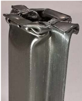
Crash-Box nach Versuch auf Fallturm
